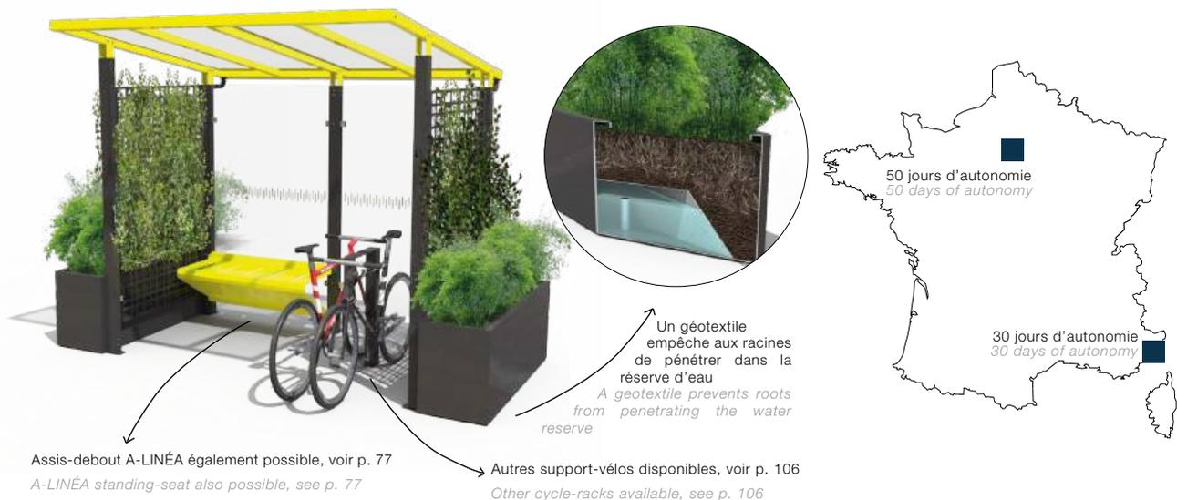
**Structure :** Aluminium peint, dimensions 3480 x 2187 x 2470 mm | **Bac :** Aluminium peint, dimensions 1500 x 450 x 600 mm ou 1500 x 750 x 600 | **Option :** Fourniture substrat et végétaux
